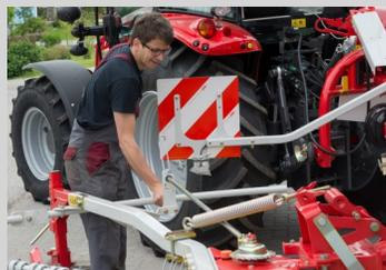
3) Stellen Sie die **Querneigung** des Kreisels mittels Exzentrerschrauben oder Spindel an der Tandemachse so ein, dass am 1. eingesteuerten Zinken ein Bodenabstand von ca. 1 cm messbar ist.
