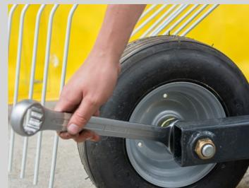
5) Stellen Sie das **Außen-** und gegebenenfalls auch das **mittlere Innentastrad** so ein, dass beide gleich belastet sind und am Zinken davor ein Bodenabstand von 2—2,5 cm messbar ist.
